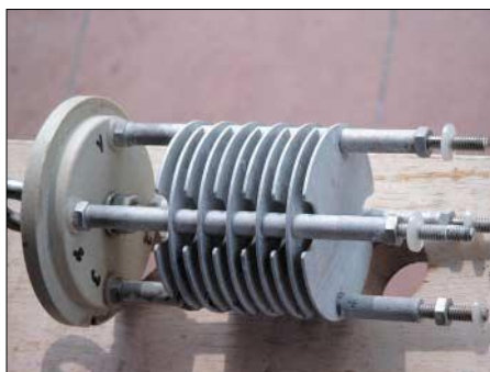
Bild 1: Ansicht des im Trap enthaltenen Kondensators; Korrosion kann hier die Kontaktgabe verhindern.
