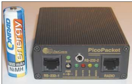
Bild 1: Ansicht des PicoPacket-TNC mit den Maßen 25 mm × 65 mm × 86 mm
