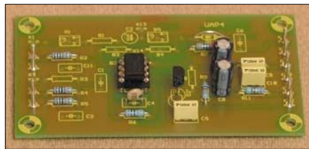
Bild 100: UAP4, verschaltet als Komparator mit Hysterese
