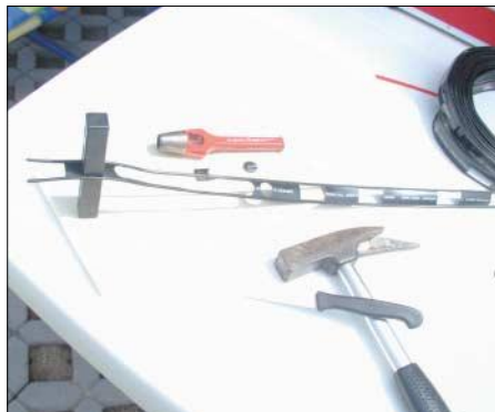
Bild 7: Heraustrennen der Mittelstege des Wireman-Kabels
