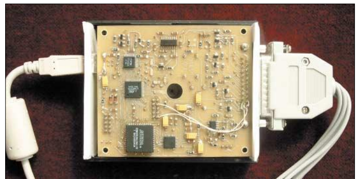
Bild 5: Prototyp des USB-Controllers für MixW ; er benötigt PC-seitig nur eine USB-Verbindung. Foto und Screenshots: DL3AYJ
