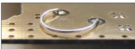
Bild 10: Der Grad des Herumbiegens der Spule L1 gestattet eine Feinabstimmung.
