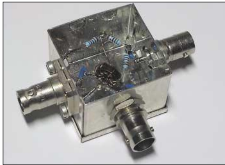
Bild 5: Aufbau einer Wheatstone-Messbrücke mit Ringkernübertrager FT 37-43 im Weißblechgehäuse 37 mm × 37 mm × 30 mm
