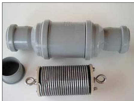
Bild 2: Wasserdichte Unterbringung von Traps u.a. in HT-Rohren bzw. Fittings aus dem Baumarkt Fotos: DL4BCB
