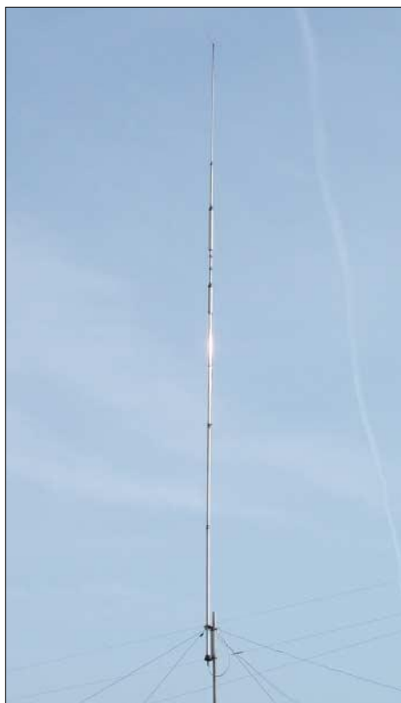
Bild 1: Restaurierte Groundplane mit neuem Aluminiumrohr anstatt des untersten Traps
