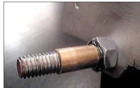
Bild 7: Mit Hilfe von Gewindebuchsen ist ein leichtes Drehen der Rotorachse in den Seitenteilen möglich. Fotos: DL7AXF
