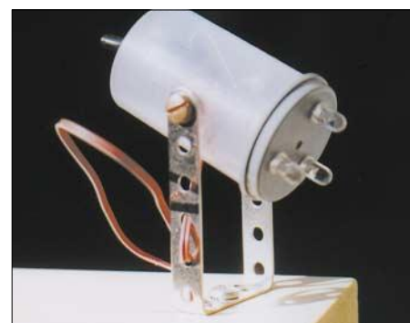
Bild 3: Die Halterung gestattet das Drehen und Schwenken des Spots. Foto: DL1MK
