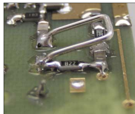
Bild 16: Die Detailansicht mit der Spule L2 verdeutlicht deren U-Form. Fotos: OK2XDX
