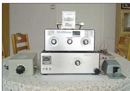
Alle Komponenten dieser Langwellenstation sind bis auf die Morsetaste selbstgebaut (aber es geht auch ohne Morsekenntnisse!). Foto: DK8AR
