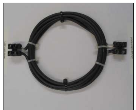
Bild 11: Koaxialkabelbalun; die Kompensationswicklung besteht hier aus 4-mm²-Rangierdraht.
