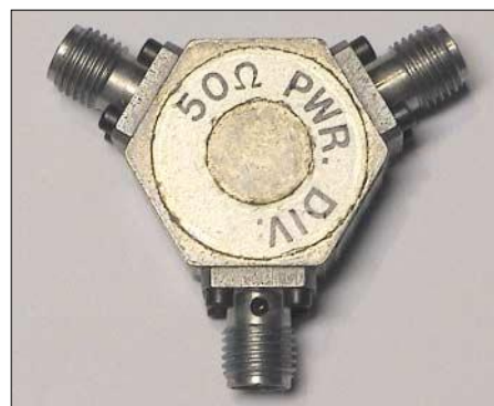
Bild 2: Beispiel eines resistiven Power-Splitters, 0–18 GHz
