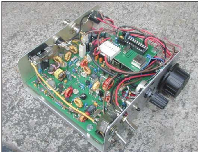
Bild 1: Da sich fast die gesamte Schaltung auf einer einzigen Leiterplatte befindet, muss man bei der Endmontage „nur“ die Bedienelemente und Buchsen mit Grundplatine und DDS-VFO verbinden.
