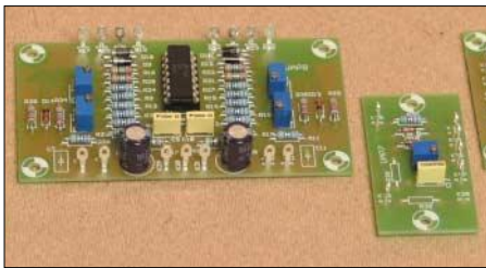
Bild 82: Komparatorplatine UAP 8 (links) und Hilfsplatine UAP7
